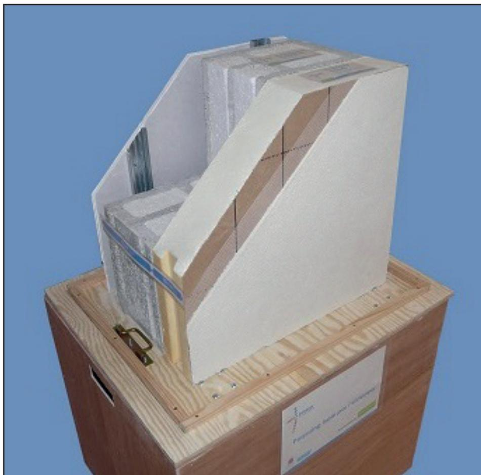
Parpaing isolé par l'extérieur par de la mousse polyuréthane et parpaing pré-isolé par du polystyrène
