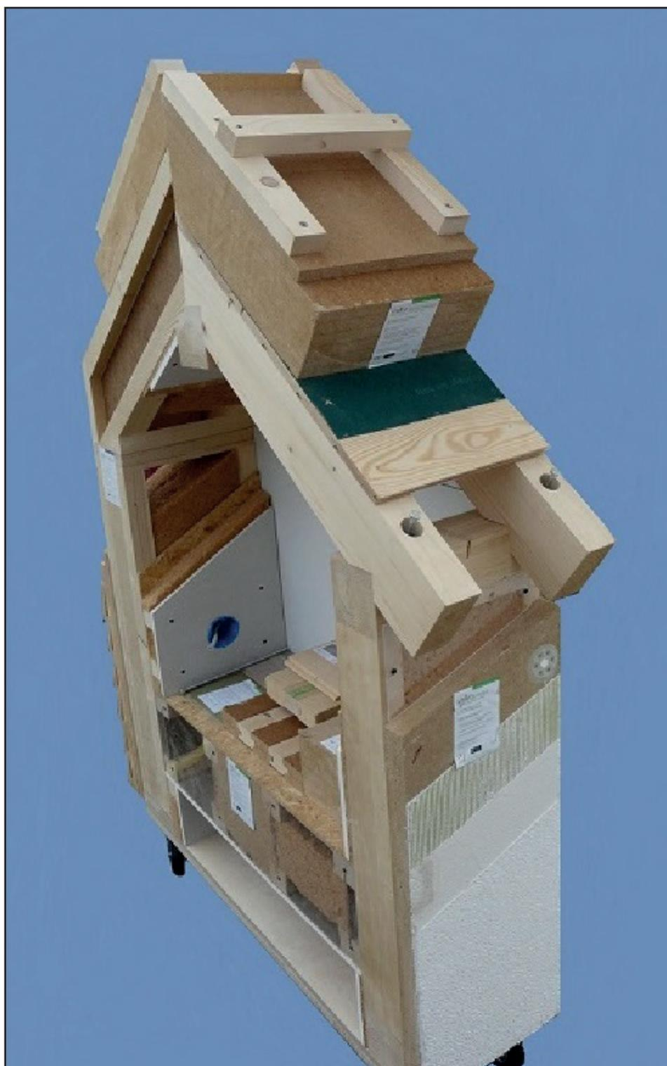
Solutions d'isolation en laine et fibre de bois pour plancher, murs et toiture.
