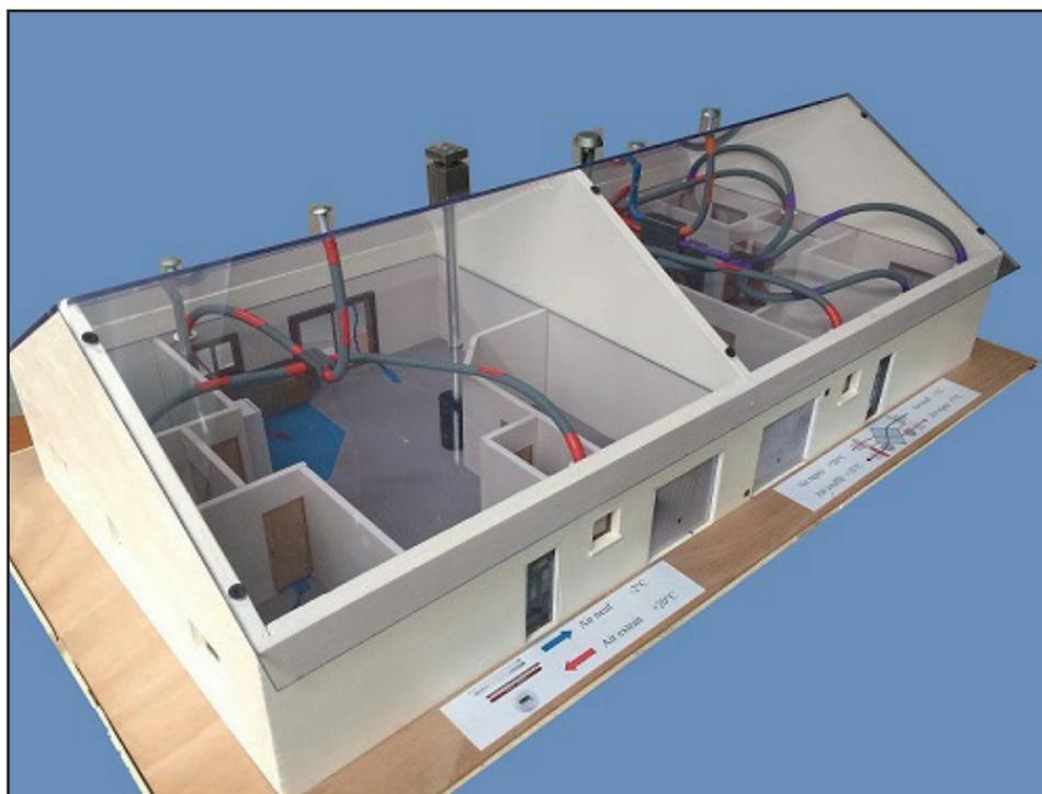
Maquette présentant les deux types de ventilation mécanique :
